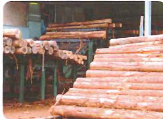
丸太の皮をむき、乾燥させ、柱やフローリングに加工する工場です。ねじれや曲がりの有無や、含水率*など、何項目もの品質検査に合格した木材だけが、みなさまのお家の材料になります。
