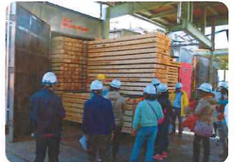
丸太の皮をむき、乾燥させ、柱やフローリングに加工する工場です。ねじれや曲がりの有無や、含水率*など、何項目もの品質検査に合格した木材だけが、みなさまのお家の材料になります。
